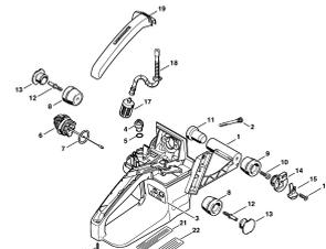
Корпус топливного бака -
