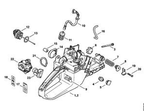
Корпус топливного бака
