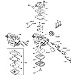
Карбюратор C1Q-S246, C1Q-S252, C1Q-S211, C1Q-S178
