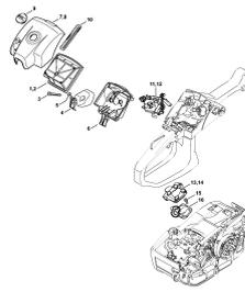
Воздушный фильтр, Крышка коробки карбюратора M-Tronic
