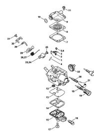
Карбюратор C1Q-S250, C1Q-S248, C1Q-S214, C1Q-S188
